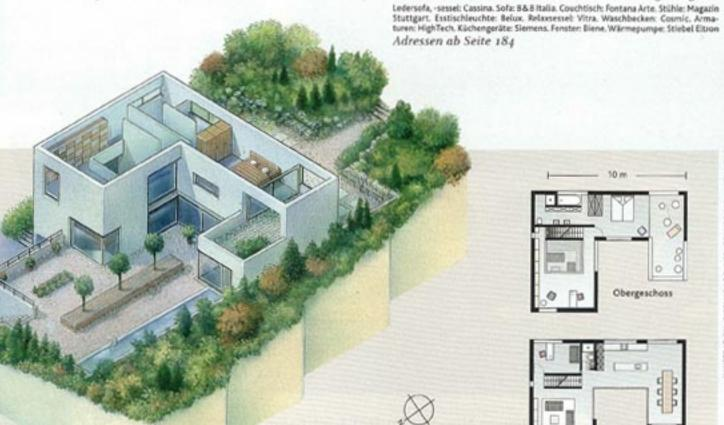
Architekt Danny Wanner Bauweise Stahlbeton (Keller, Treppenkern). Ziege Imauerwerk, Warmeverbundsystem Heizung Luft-Warmepumpe mit Fußbodenheizung Wohnfläche 180 mf Grundstücksgröße 707 mf Bauzeit 8/03 bis 5/04 Baukosten 900 000 str
